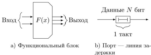
Рис. 7.3. Два класса элементов, используемых при тактовой симуляции
