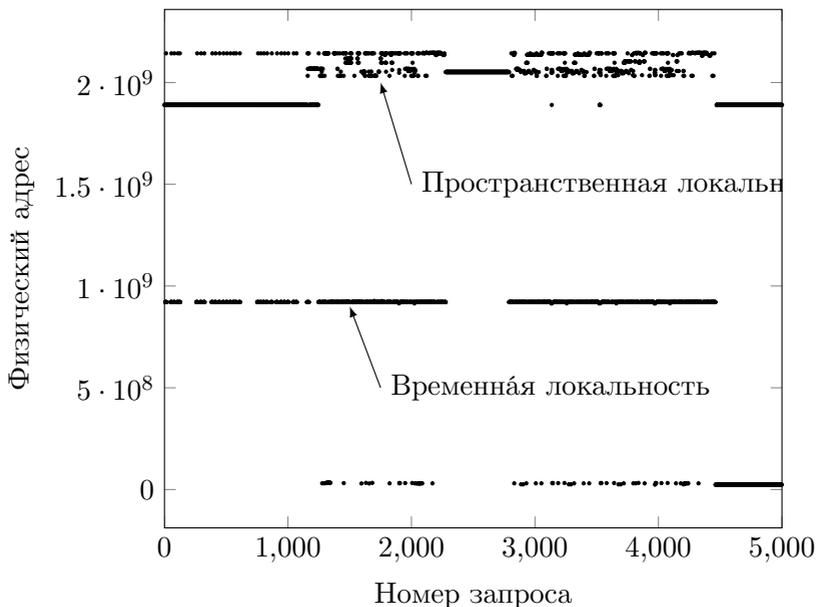
Рис. 9.2. Пример явлений временной и пространственной локальности доступов памяти при работе приложения. На графике показаны первые 5000 доступов к данным в памяти для программы `splash2x.fft` из набора PARSEC 3.0 [1], скомпилированной для Ubuntu 12.04 x86\_64
