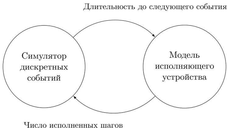
Рис. 5.3. Косимуляция моделей исполняющих устройств и DES. При каждой передаче управления соответствующая модель сообщает другой о том, насколько было продвинуто симулируемое время
