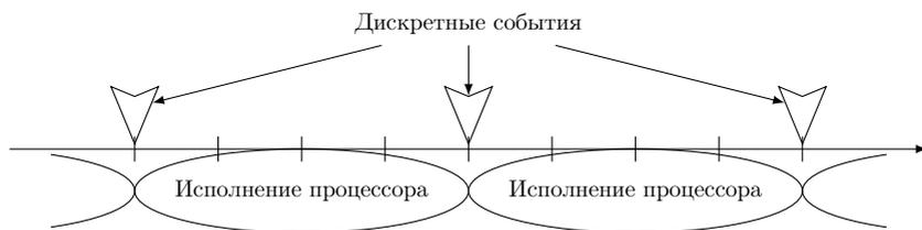
Рис. 5.2. Симуляция исполняющего устройства, перемежающаяся с обработкой дискретных событий
