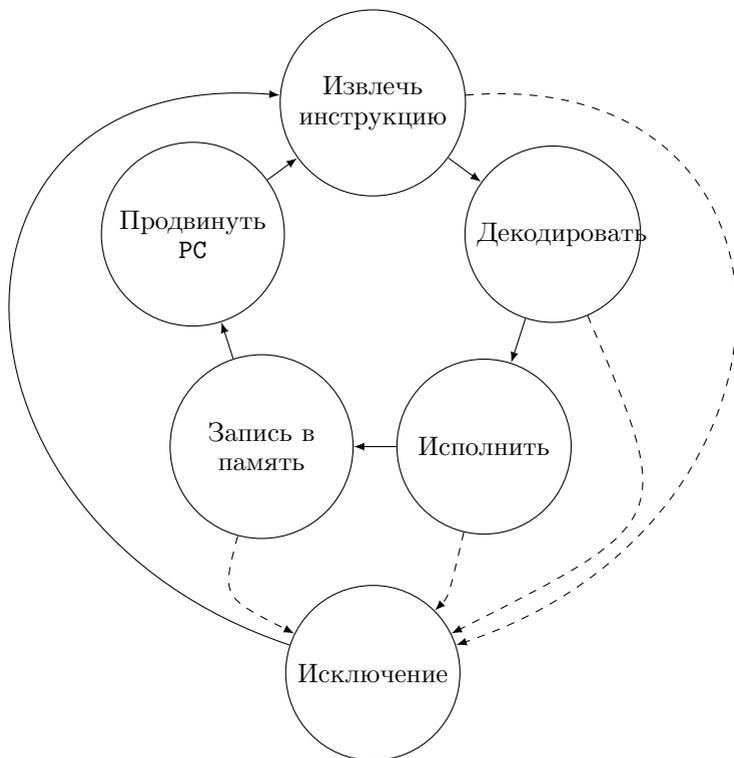
Рис. 2.2. Рабочий цикл интерпретатора. Показана возможность возникновения исключительной ситуации на любой стадии симуляции
