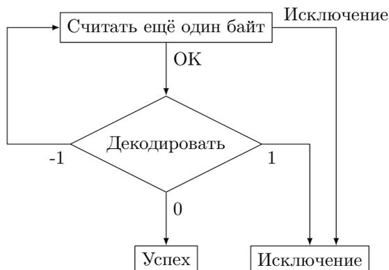
Рис. 2.3. Блок-схема декодирования, учитывающая переменную длину инструкции
