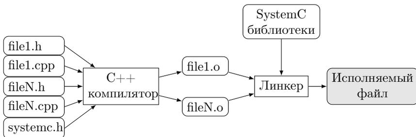
Рис. 10.3. Последовательность сборки модели SystemC из исходных кодов
