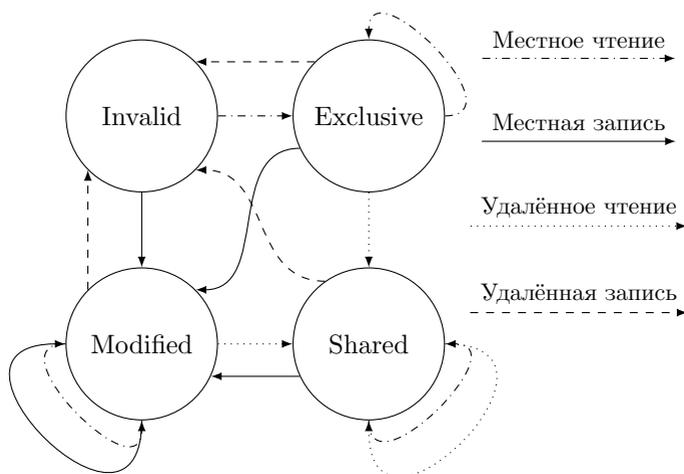
Рис. 9.6. Диаграмма переходов протокола MESI. Доступ является местным, если он был инициирован процессором данного кэша, и удалённым, если запрос возник в любом другом
