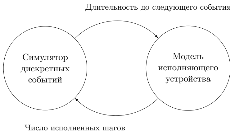
Рис. 5.11. Косимуляция моделей исполняющих устройств и DES. При каждой передаче управления соответствующая модель сообщает другой о том, насколько было продвинуто симулируемое время
